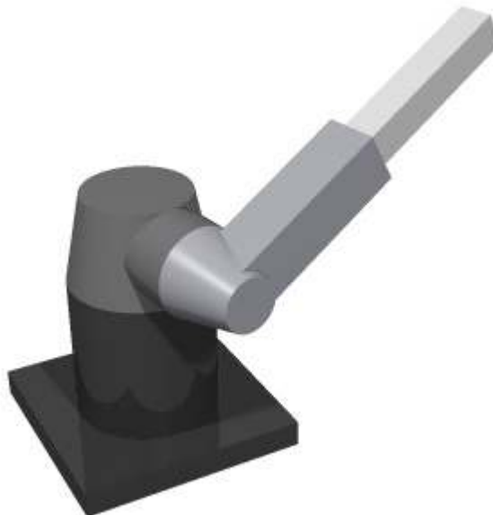
Figura 3.15– Robô polar em configuração VFL .
